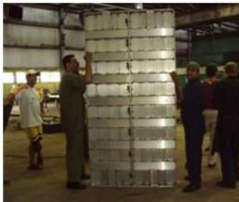
Figura 2. Panel 600x2400 mm de aluminio 6061 T4 puesto a prueba en obra.
